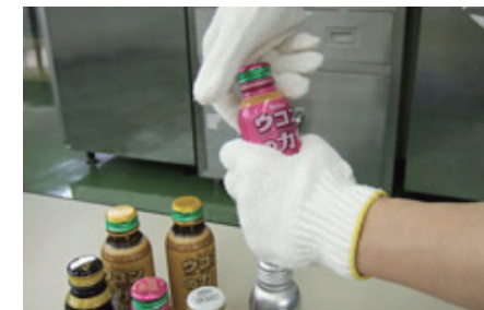
手袋をして高齢者の手の状態を再現、キャップの開栓性を確認。
