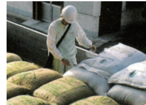
工場に届いた原料の抜き取り検査
