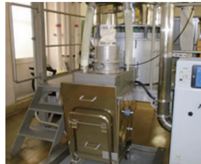
小麦粉シフター(ふるい)。小麦粉を投入する際、万が一の異物を除去します。
