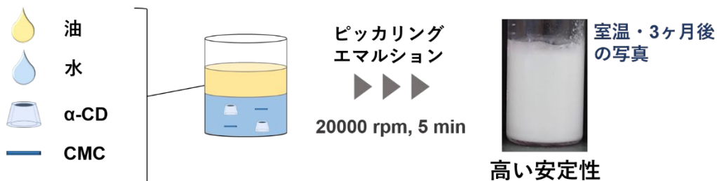
図2. 本エマルジョン形成技術の概要と安定性
