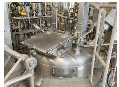
静岡工場のレトルト製造工程内にある「クッカー」と呼ばれる大きな釜
