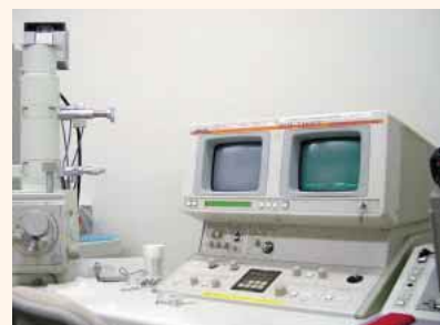
異物の表面や内部の微細構造などについて「電子顕微鏡」で観察し、異物の特定・混入原因の推定などに取り組んでいます
