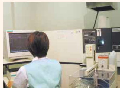
食品に含まれるナトリウム、カルシウム、カリウムなどミネラルの量を「高周波プラズマ発光分析装置」により量り、栄養成分の分析を行います
