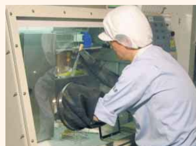
温度と酸素濃度を一定に保つ「嫌気性インキュベーター」は、酸素を嫌う細菌の培養に使用されており、衛生性に関する試験で用いられています
